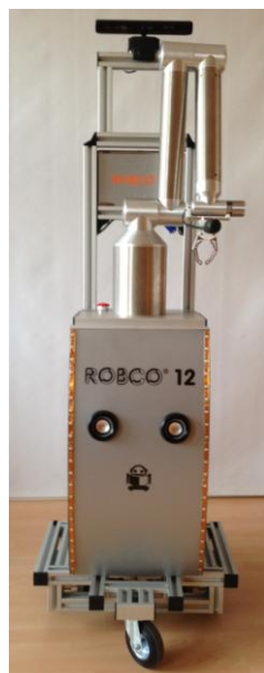
ФИГ.5 Сервизният мобилен робот “Робко 12”, разработен в рамките на Европейски проект за подпомагане на хора със специфични потребности, екипиран със сензорни и софтуерни системи, създадени в ИСИР-БАН.
