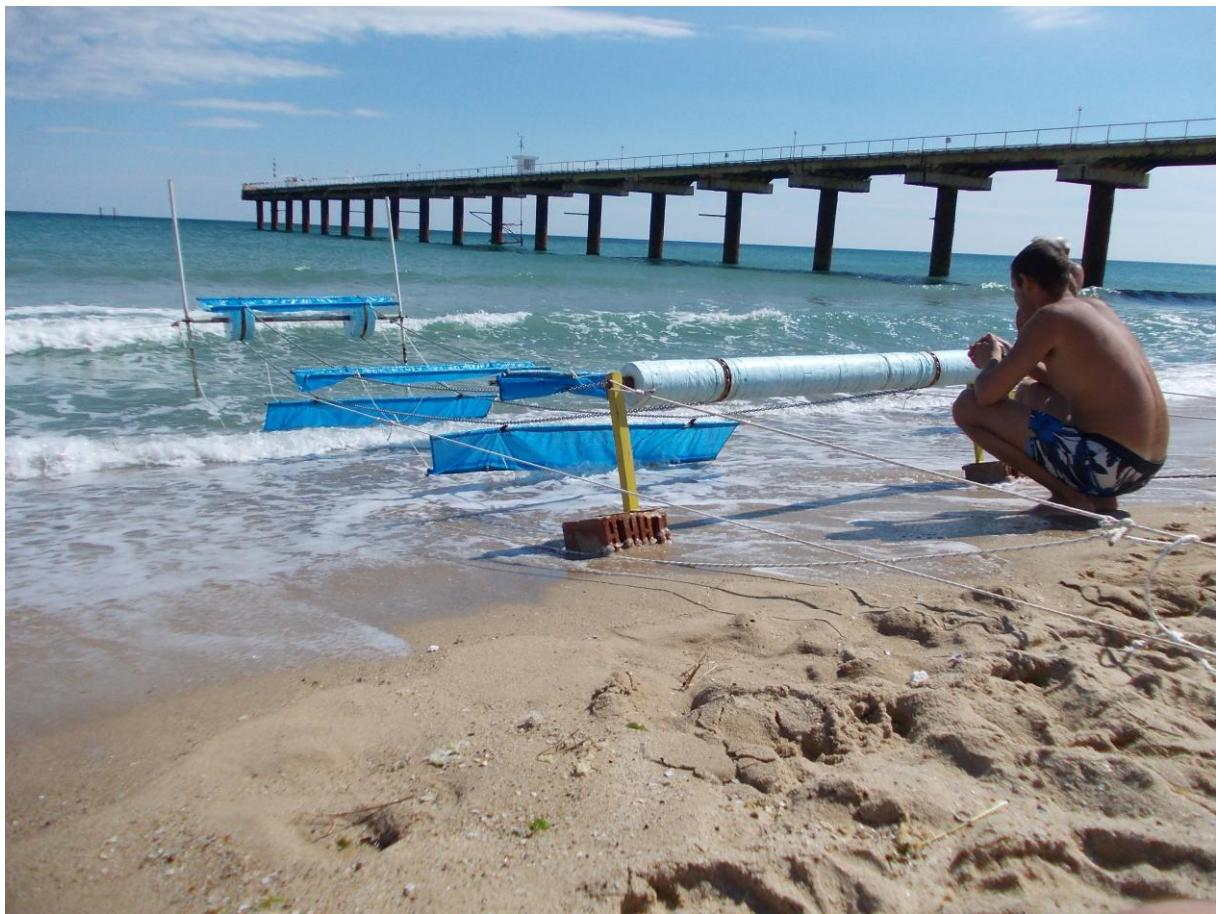
**ФИГ.2** Роботизирано устройство за получаване на електрическа енергия от морските вълни-функциониране в реални условия край Шкорпиловци.
