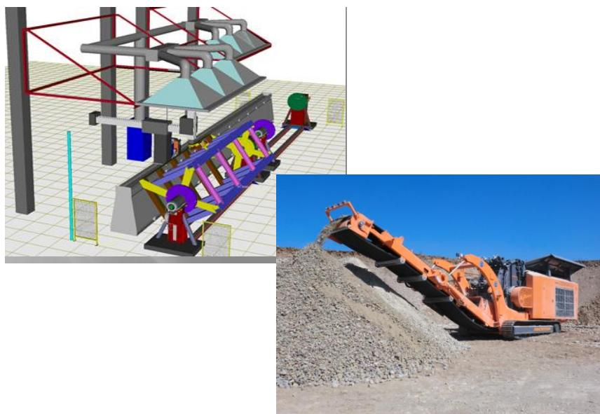
**ФИГ.5.** Когнитивна роботизирана заваръчна система за голямогабаритни детайли на каменотрошачни машини за фирма „ТМКо“, гр. Дебелец.
