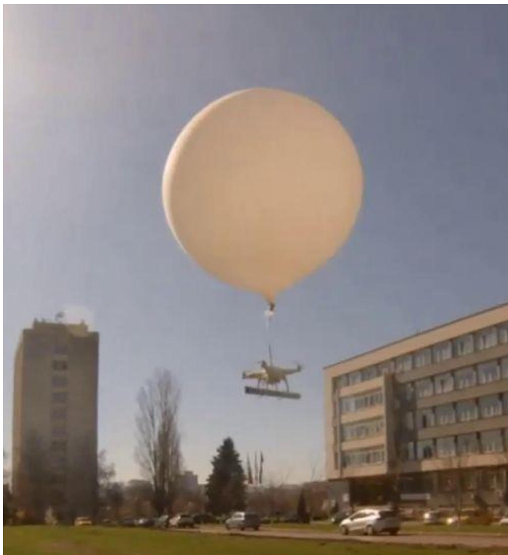
Фиг. 4. „Шпионска“ технология, съдържаща многомерен магнитометър, балон с хелий и мултиротор за целите на сигурността
