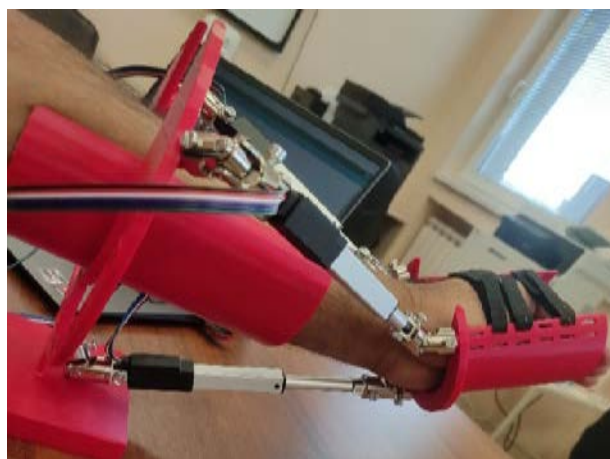
Роботизирано устройство за рехабилитация на китка след прекаран инсулт
