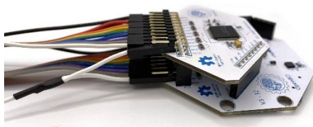
(фиг. 26) Финално свързване на електродите към платка CytonDaisy
