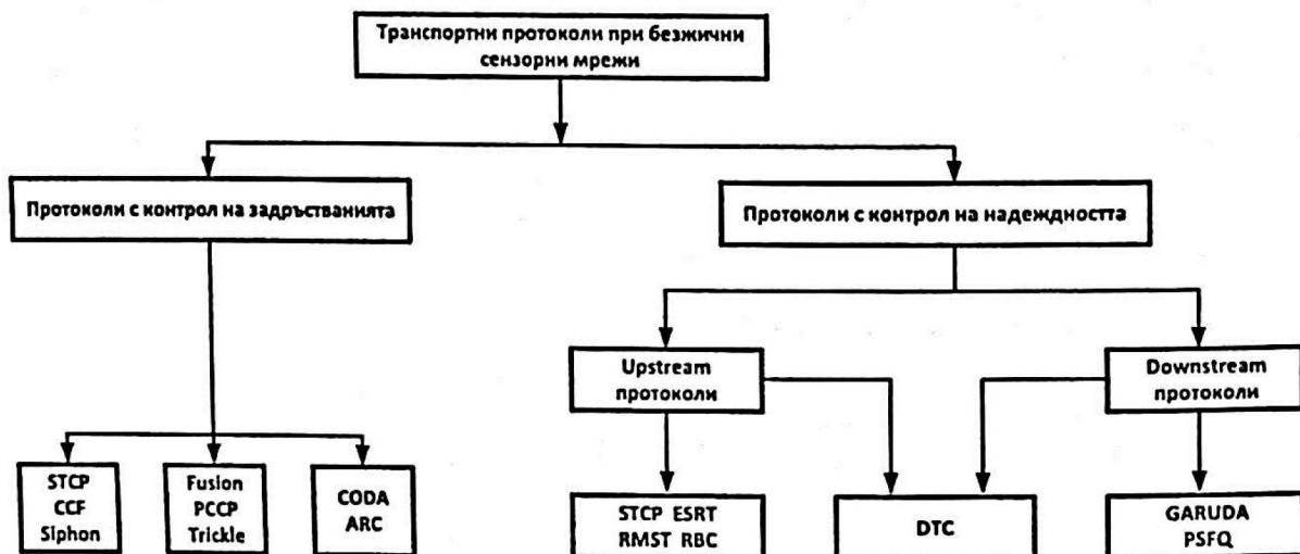
*Фиг. 16. Класификация на основни протоколи за контрол на трафика*
