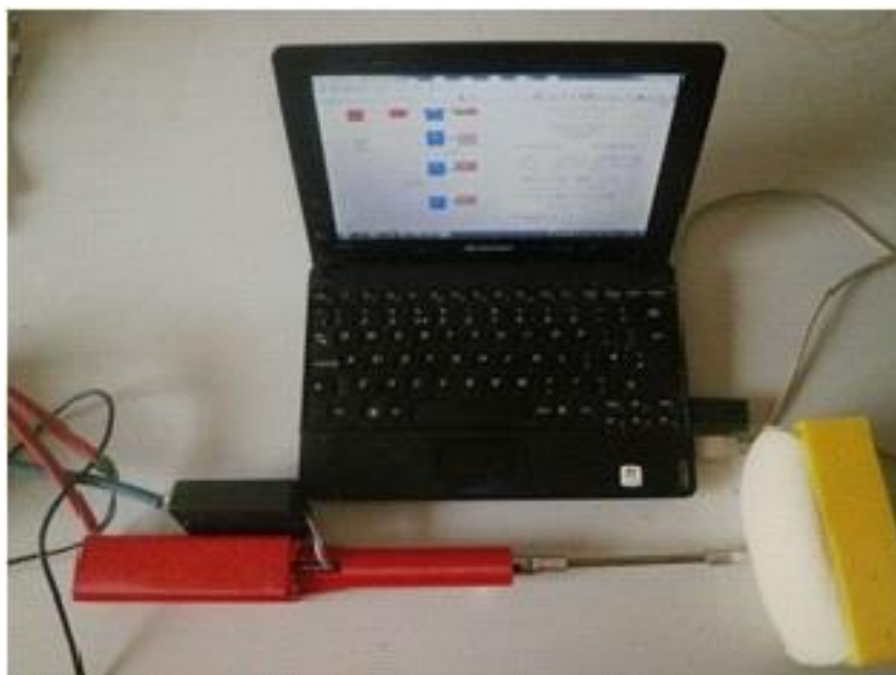
Фиг5.7. Опитен модел на инструмент с вградени силови сензори, който се управлява от компютър.
