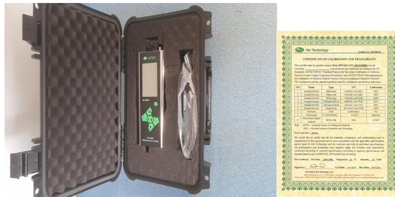
Фиг. 3.5. Брояч на аерозолни частици Hal-НРС601 и неговото сертифициране от производителя
