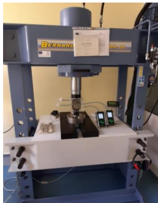
Фиг. 4.2. Хидравличната преса със скален образец от гранит за изследване на емисиите на микрочастици при едноосно натоварване
