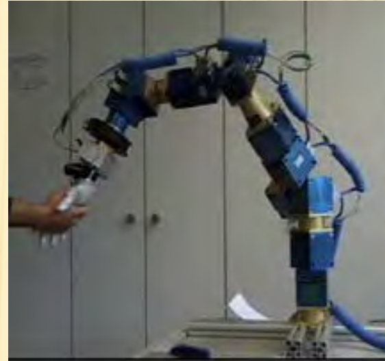
Изследване на манипулативността на робот със седем степени на свобода модулна конструкция на фирмата AMTEC ROBOTICS - Германия.
