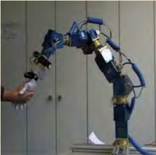
Изследване на манипулативността на робот със седем степени на свобода модулна конструкция на фирмата AMTEC ROBOTICS - Германия.
