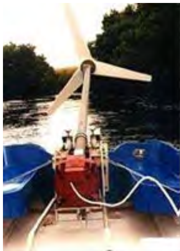
Фиг.1. Понтонна ВЕЦ с аксиално задвижвана турбина
