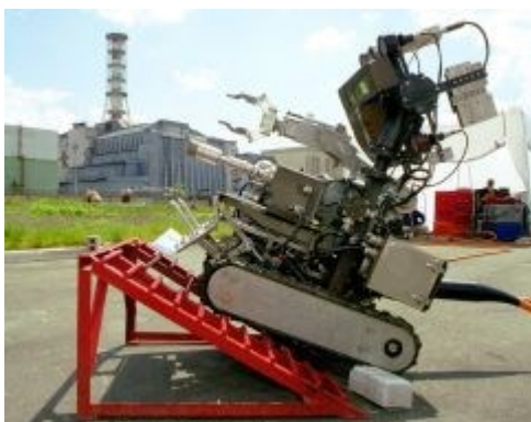
Фиг.6. Мобилен робот „Pioneer“ в атомната електроцентрала в Чернобил.
